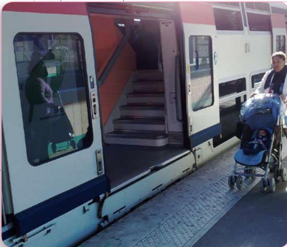
On remarque sur cette photo d'une rame SNCF ALTEO en service, que le niveau du quai et celui du seuil des portes de la rame (ligne bleue foncée) ne correspondent pas. Il faut franchir une haute marche pour monter ou descendre du train.
