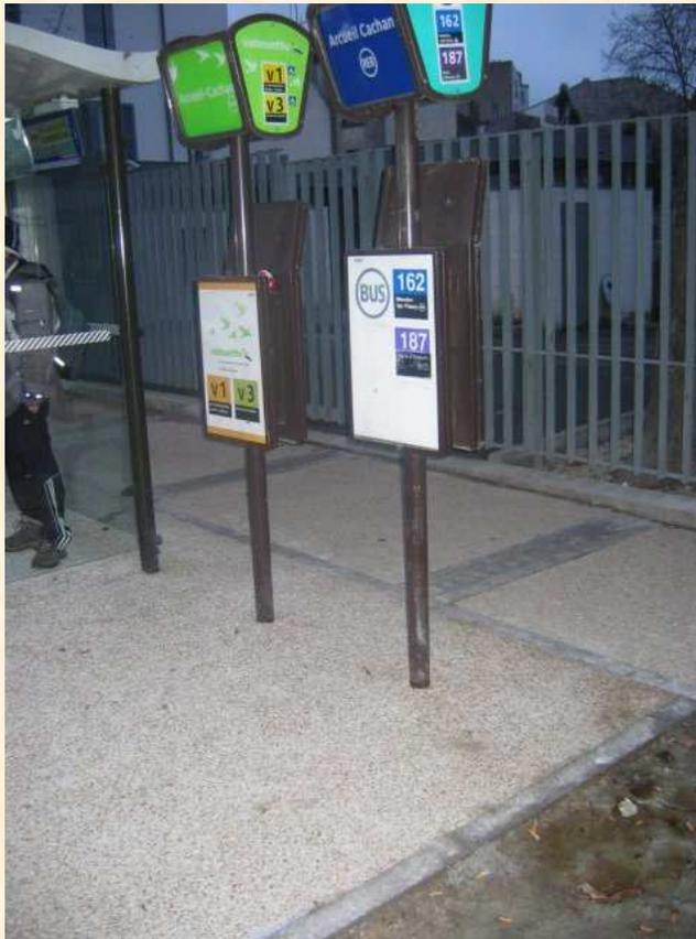
Les poteaux d'arrêt font obstacle entre l'arbre et l'abribus et rendent l'arrêt non conforme aux prescriptions du STIF pour les PMR
